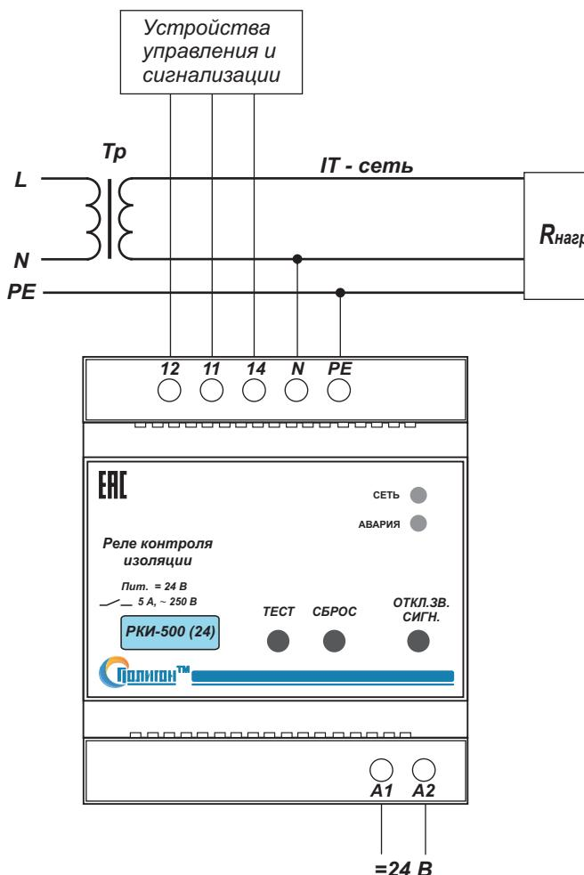
Рис.1. Типовая схема подключения блока РКИ-500 (24).
